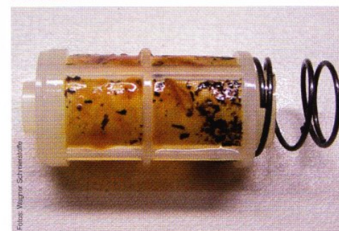
Verlegter Filter: Mikroorganismen bilden einen schleimartigen Rückstand, der nicht nur den Filter verstopft, sondern auch für Korrosionsschäden verantwortlich ist.
